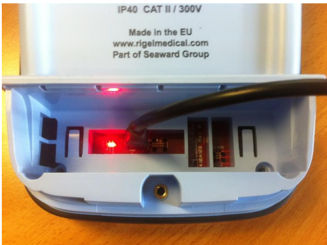
Rysunek 1. Widok Safe Test 60 ze zdjętą pokrywą i podłączonym przewodem mikro USB
